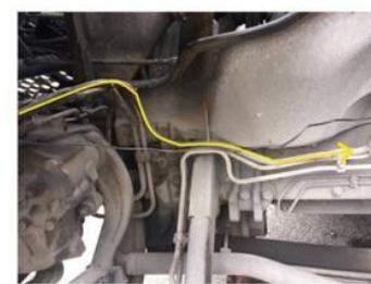
トラクターヘッドの下のハーネスに沿ったケーブル接続
