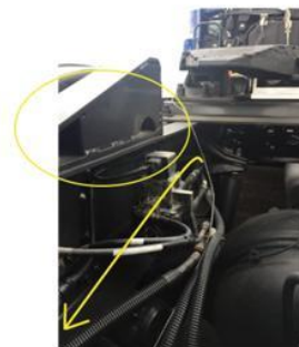
トラクターのリアバンパーに固定された受信中継機
