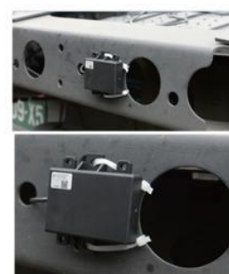
トラクターのリアバンパーに固定された受信中継機
